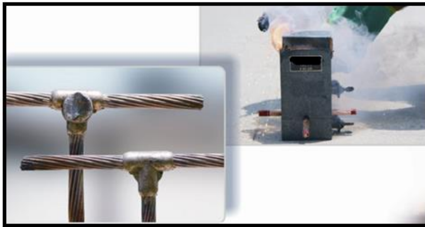
شکل (۸-۲): جوش اگزوترمیک (احتراقی)
